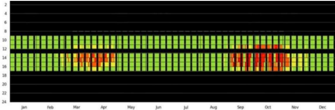
**Figura 5:** Gráfica de deslumbramiento orientación norte (vista a la ventana), sin sistemas de control solar
